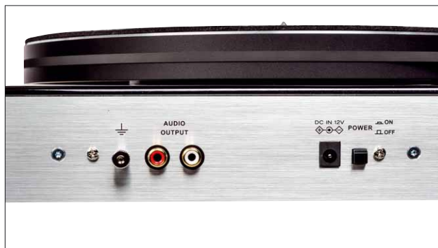
Alle nötigen Anschlüsse befinden sich gut zugänglich an der Rückseite. Löblich: Ein Netzschalter findet sich hier ebenfalls
