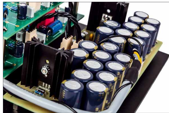
Siebung satt: Jede Menge Elkos glätten die Betriebsspannungen für die Phonovorstufe
