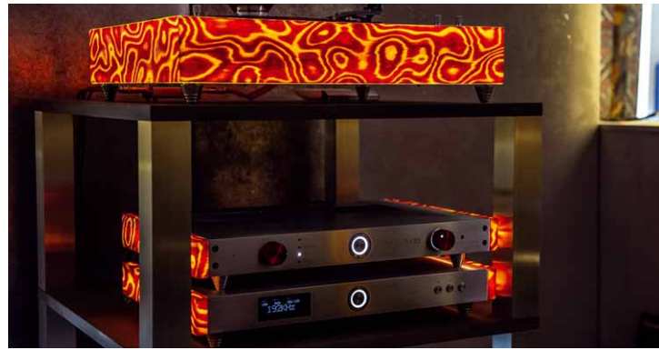
Die exotische Optik dieser Geräte kommt mithilfe von hinterleuchtetem Holzfurnier zustande
