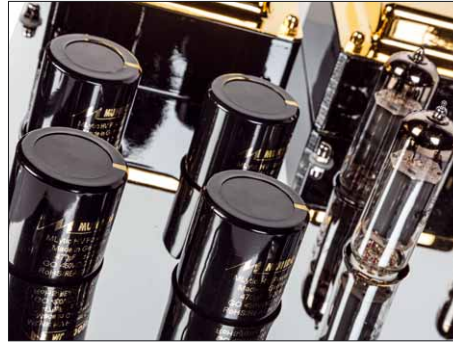
Im Vergleich zur Stereo-Endstufe hat sich die Siebkapazität pro Kanal verdoppelt
