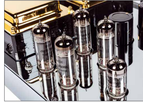
Eine ECC82 als Eingangsstufe, vier EL84 als Endröhren in einer PPP-Schaltung. Die Röhren stammen alle von Electro Harmonix
