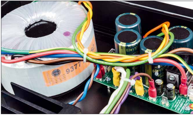
Der Trafo des I8 ist zum großen Teil fürs erkleckliche Gewicht des Gerätes verantwortlich
