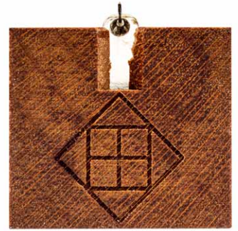
Leider nicht selbstverständlich. So sieht ein gerade montierter Nadelträger aus
