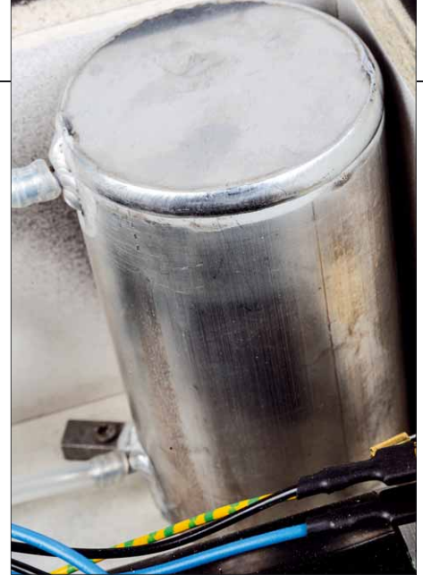
Blechklempnerei vom Feinsten: Der „Abwassertank“ der Maschine ist eine Metallkonstruktion
